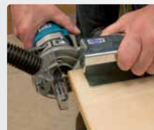
Обработка углов методом обкатки.
