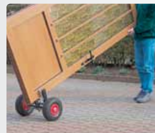
Позволяет одному человеку удерживать и перемещать изделия весом до 200 кг
