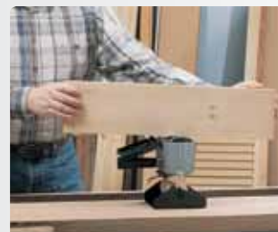
Нанесение клея на узкие поверхности.
