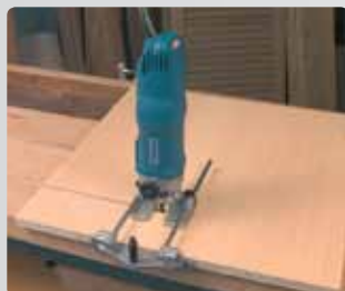
Прорезка параллельных пазов с помощью универсального упора
