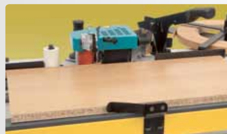
Электронная регулировка скорости приклейки под управлением микропроцессора
