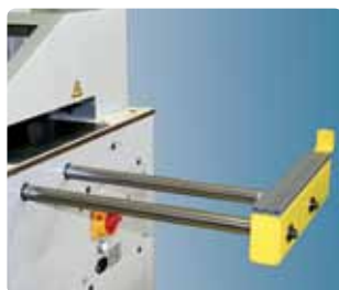
Выдвижная опора для больших деталей.
