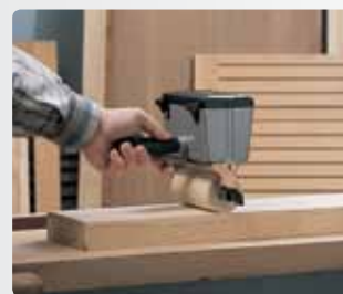
Нанесение винилового (белого) клея
