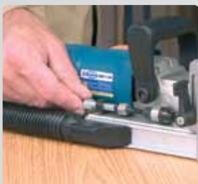
Быстрая регулировка глубины паза.
