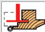
Прорезка паза на окне со стороны петель.
