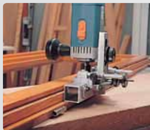
Прорезка паза на окне со стороны петель.
