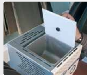
Легкий доступ к клеевой ванне, расположенной в верхней части станка. Система содержит легкоочищаемый силиконовый ролик.
