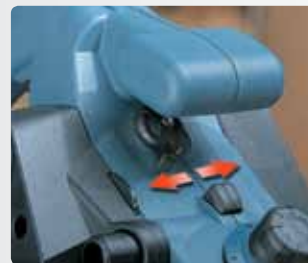
Переключатель направления выброса стружки.
