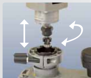
Новая система точной настройки вылета фрезы.
