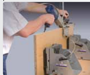
Фиксация крупногабаритных деталей при помощи дополнительного модуля SVN470.
