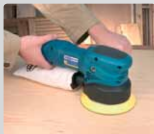
Применяется для обработки больших поверхностей.
