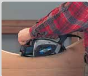
Строгание вогнутых поверхностей.
