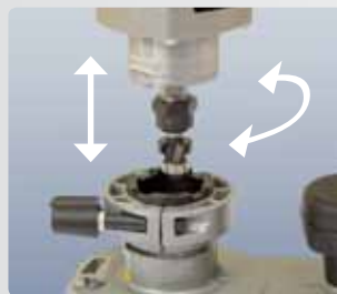
Новая система точной настройки вылета фрезы.
