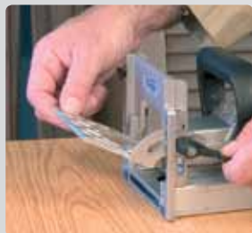
Угол и высота регулируется по встроенным шкалам.
