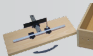
Отверстия для установки декоративных накладок ящиков.
