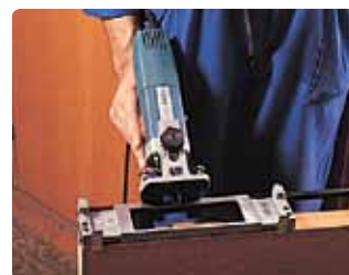
Фрезерование на дверном полотне (Модель АО93)
