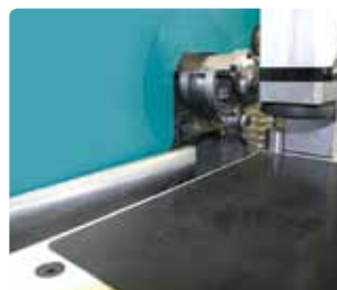
Упор со стороны обрабаты- ваемого кромочного материала.
