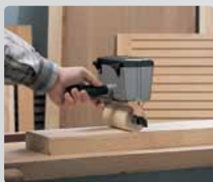
Нанесение винилового (белого) клея
