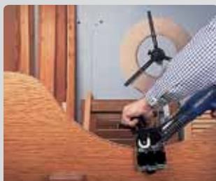
Облицовка вогнутых и выгнутых деталей
