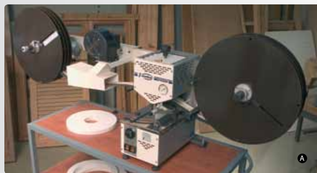
Станок позволяет наносить клей на полосы ламината, пластика или древесисины, без использования модуля намотки.
