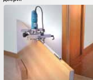
Обработка дверной коробки и дверного полотна осуществляется без переналадки
