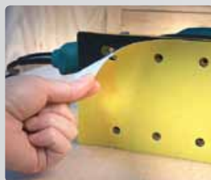
Использование самофиксирующихся (velcro) абразивных материалов
