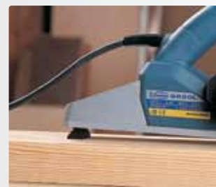
Опорный башмак, предотвращающий повреждение ножей и поверхности детали.
