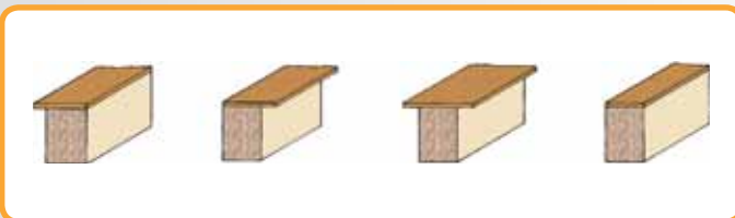
4 возможности распределения свесов кромочного материала
