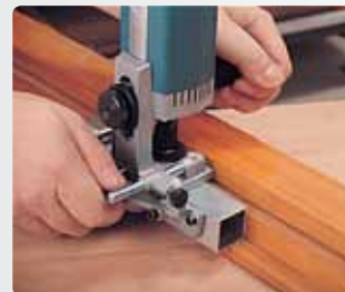
Прорезка паза на окне со стороны замка.
