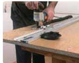
Точный и качественный прямолинейный пропил по шине УCP90
