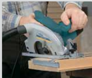
Выполнение наклонного реза.
