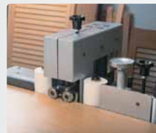
Моторизованный блок для снятия свесов кромки: одновременная подрезка свесов с обеих сторон детали.
