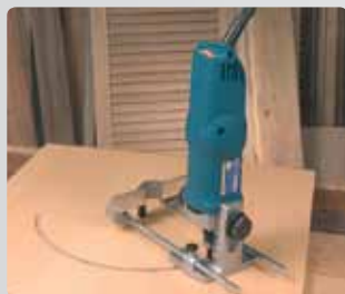
Прорезка круговых пазов с помощью универсального упора
