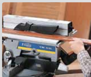
Верхний столик для вспомогательных работ. Глубина пропила регулируется от 0 до 50 мм
