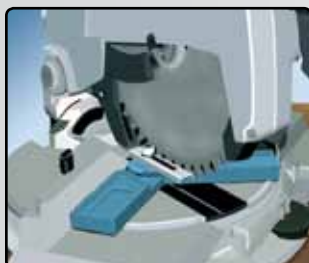
Перенос угла на режущий инструмент.
