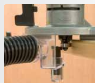
Кожух пылеудаления с тормозом внешней обоймы подшипника фрезы для предотвращения повреждения обрабатываемой детали.
