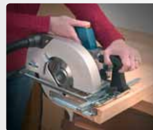
Глубина пропила до 70 мм.
