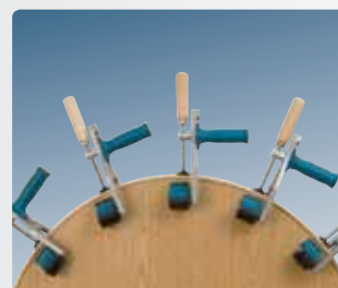
Фиксирование торцевых накладок на выгнутых панелях
