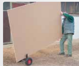
Перемещение крупноформатных заготовок, в том числе по неровным полам и ступеням.
