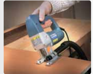
Основание регулируется в диапазоне от 0° до 45°.
