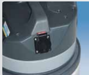
Розетка для подключения электроинструмента (система синхронного старта).
