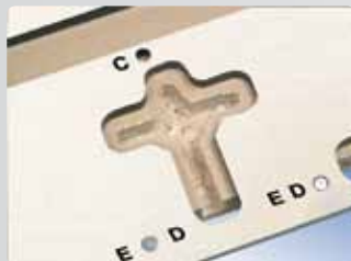
Фрезерование крестообразного паза под стяжку.
