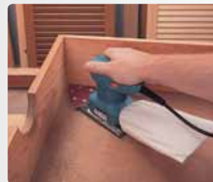
Использование дельтообразной подошвы для обработки труднодоступных мест.
