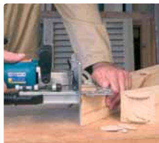
Соединение "в ус" для нагруженных соединений
