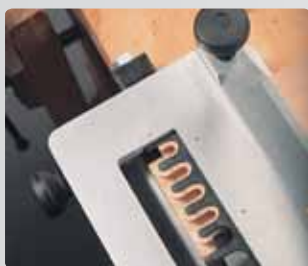
Начальная точка фрезерования шипов может регулироваться
