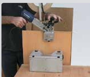
Облицовка вогнутых и выгнутых деталей
