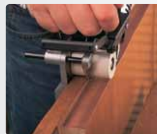
Облицовка верхней поверхности на двери с притвором.
