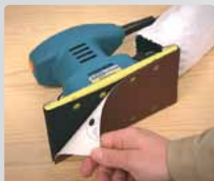
Основы для крепления самофиксирующихся (velcro) абразивов
