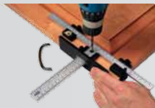
Отверстия для установки мебельных ручек.
