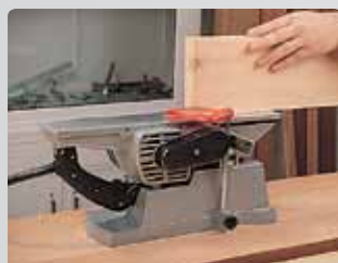
Основание для использования рубанка в стационарном положении с защитой ножей.
