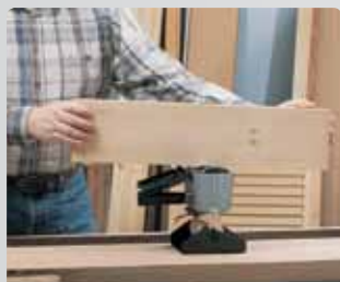
Нанесение клея на узкие поверхности.
