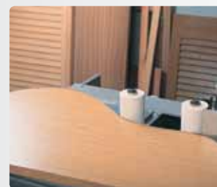
Облицовка вогнутых и выгнутых деталей (при демонтаже блока снятия продольных свесов)
