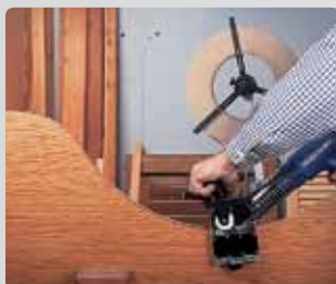
Облицовка вогнутых и выгнутых деталей
