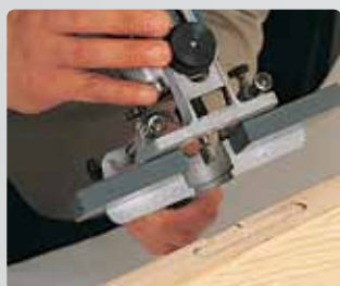
Установка петель с насадкой ZB93.
