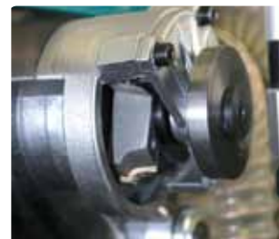
Фреза и копир конструктивно независимы.
