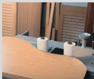
Облицовка фигурных поверхностей.
