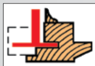
Прорезка паза на окне со стороны водостока.
