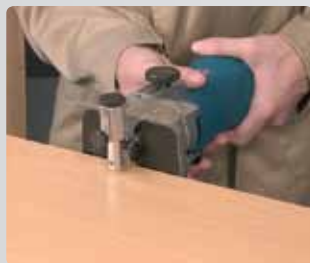
Снятие свесов кромочного материала
