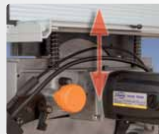
Новая система настройки настройки положения верхнего стола обеспечивает точную и плавную настройку.
