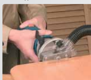
Круглая насадка (V3) входит в стандартную комплектацию. Применяется для фрезерования с базированием от торца заготовки.
