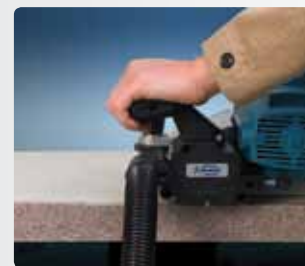
Обработка кромочных планок из искусственного камня.
