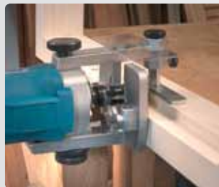
Подрезка фальцев (необходимо использовать фрезу арт. 1240046 и опорный башмак арт. 1250041 или арт. 1850042)
