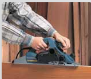
Регулировка глубины строгания осуществляется с шагом 0,2 мм.
