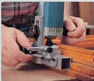
Прорезка паза на окне со стороны водостока.
