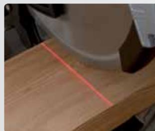
Лазер установлен на прижимной шайбе пильного диска, что обеспечивает точность при любом положении пильного диска.
