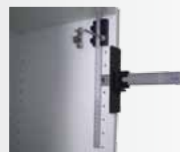
Отверстия для установки держателей полок.
