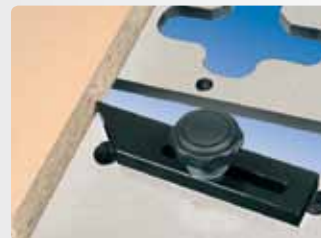
Регулируемый стопор для точного позиционирования шаблона.
