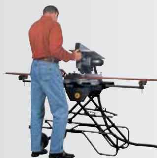
Перенос угла на режущий инструмент.
