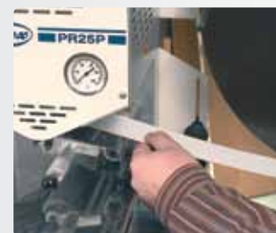
Установка кромочного материала.
