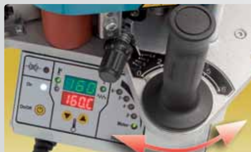
Электронная регулировка температуры и скорости.
