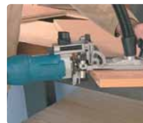
Обработка свесов кромки цилиндрической фрезой
