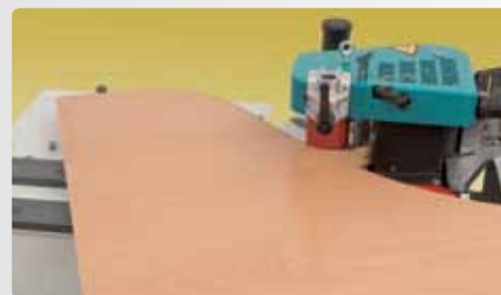
Оснащен дополнительным роликом для облицовки криволинейных деталей.
