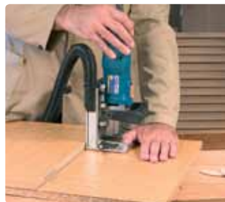
Соединение по плоскости панели.
