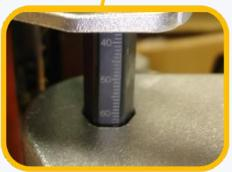
Опорная площадка с нанесенной лазером миллиметровой шкалой (Virutex PEB250, Adamik и Karmei) и сменной накладкой для улучшения скольжения. Нагревательный элемент: Предназначен для предварительного прогрева торца детали, на который осуществляется приклейка кромочного материала
