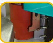
Настраиваемый упор на выходе для обеспечения параллельности панели и кромочного материала (Virutex PEB250 и Adamik 62XL).
