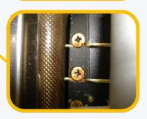
Дополнительные ограничители- направляющие для исключения намотки кромочных материалов на клеенаносящий вал (Virutex PEB250 и Adamik 62XL).
