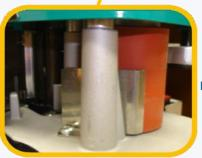
Ограничительнаправляющая Исключает наматывание кромки на прикатывающий ролик при обработке криволинейных деталей (только Virutex PEB250).
