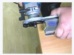
Фрезер оснащен двигателем с двойной изоляцией, системой электроники (для поддержания заданной частоты вращения под нагрузкой), системой сохранения настроек при смене фрезы и системой пылеудаления, интегрированной с системой торможения внешней обоймы опорного подшипника фрезы.
