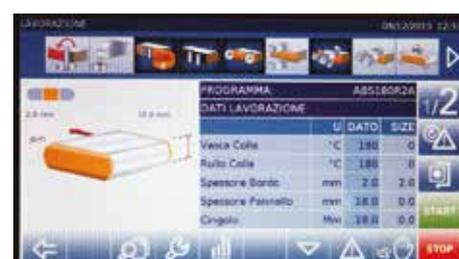
**Touch 7 Control:** безошибочное управление станком одним касанием с использованием сенсорного экрана с персонализированной графикой, интуитивно понятным и простым выбором основных функций станка.
