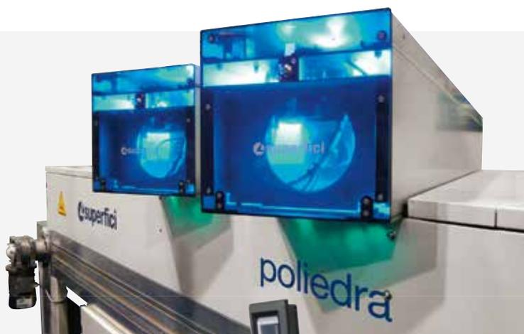
**POLIEDRA** - система УФ-отверждения лакокрасочных материалов, наносимых на изделия с толщиной до 80-100 мм, движущиеся в горизонтальной плоскости. Особая конфигурация отражателей повышает равномерность распределения энергии между пластинами и кромками панелей, которые, как правило, окрашиваются на линиях методом распыления.
