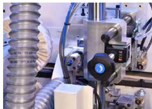
**Кромки с 3 различными радиусами** могут обрабатываться благодаря использованию полностью автоматических мультирадиусных рабочих групп, которые позволяют производить быструю и безошибочную настройку при переходах от одной обработки к другой.
