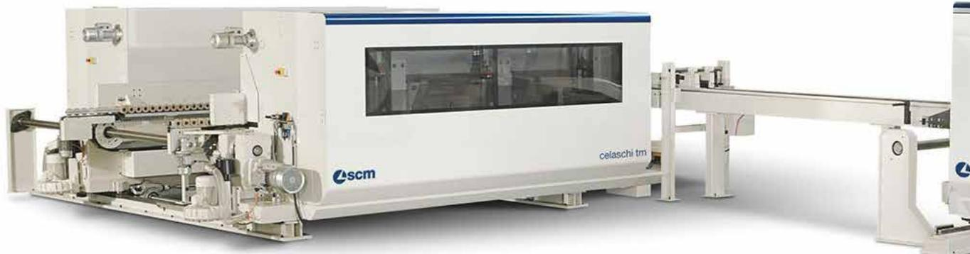
Новый профилирующий станок **celaschi tm** с интегрированной структурой для производства двух и трех слойного ламинированного паркета, с пазогребневой системой фиксации или соединением “click”.
