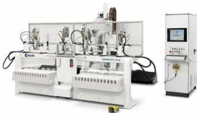
**balestrini viva** - это обрабатывающий центр с ЧПУ с 5-ю осями, созданный специально для обработки стульев и подобных изделий, на котором выполняются пазы и шипы с различными размерами и углами наклона, а также операции торцевания под различными углами, множественные сверления и фрезерования сложной формы.
