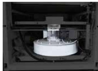
**Электровентилятор:** располагаемый под рабочим столом, позволяет уменьшить занимаемое станком пространство и снизить уровень шума.
