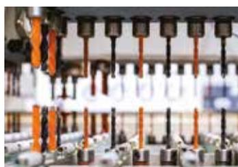
**Прекрасное качество сверления** благодаря новой технологии RO.AX (Rotoaxial spindle technology - Роторно-осевая технология шпинделя) - самому совершенному шпинделю на рынке, имеющему скорость вращения до 8000 об/мин.
