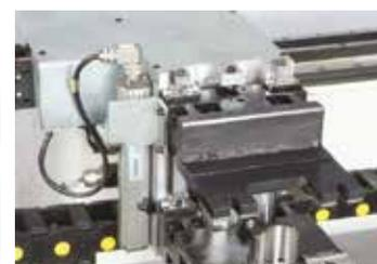
**Сокращение времени цикла** обработки благодаря новой форме захватов, которые позволяют производить обработку панелей даже в зонах, перекрытых самим захватом, без необходимости их перепозиционирования.
