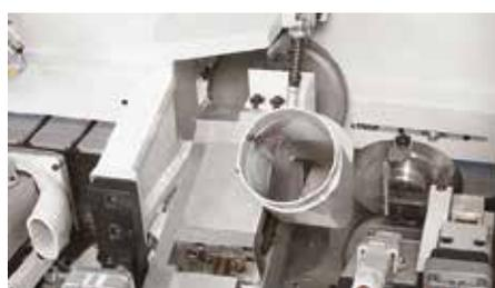
**Управляемые оси** позволяют производить любые промежуточные позиционирования группы фрезерования и циклевания кромки для оптимального качества обработки даже в случае поверхностей с кривизной или панелей с защитной плёнкой. Каждая группа позволяет обрабатывать 2 различных радиуса и бесконечное количество типов тонкой кромки и массива.
