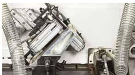
**“Round X”:** высокая производительность и качество обработки благодаря двухмоторной конструкции. Благодаря своей конструкции этот узел может использоваться одновременно для обкатки углов и снятия свесов кромки по пласти.
