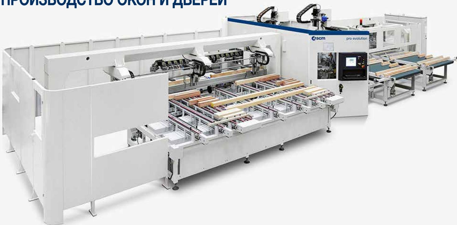
**Pro evolution** Автоматическая ячейка для производства столярных изделий и оконных блоков, обеспечивающая максимальную гибкость благодаря возможности обрабатывать последовательно детали, полностью отличных одна от другой.
