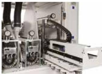
**Группа вращающихся дисков:** имеет боковую осцилляцию и два ряда дисков с взаимно-противоположным вращением, что позволяет производить более эффективную шлифовку на углах и достигать даже самых недоступных зон профилированной панели.
