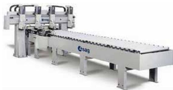
Круглопильный станок **sag sl** предназначен для пакетного раскроя полноформатных плит на полосовые заготовки в продольном направлении. Благодаря широкому выбору устройств для перемещения и сортировки заготовок до и после раскроя этот станок может применяться в производственных линиях любого типа.
