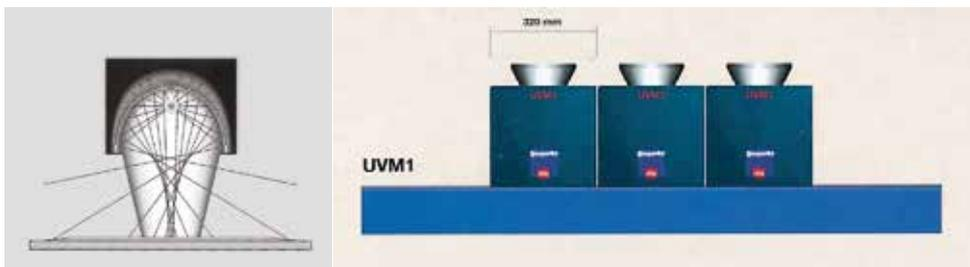
**UV PLUS** - система с параболическим рефлектором и дополнительным зеркалом с селективным спектром отражения. Зеркало отражает только ультрафиолетовую составляющую спектра излучения лампы, поглощая инфракрасную составляющую, благодаря чему система обеспечивает более “холодную” полимеризацию.
