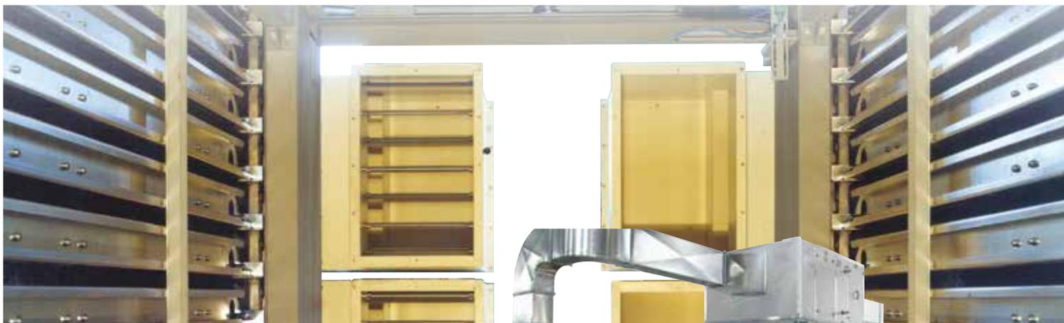
Вертикальная сушильная камера **CONTIVERT** используется в тех случаях, когда лакокрасочному слою требуется долгая сушка. Камера делится на зону испарения растворителя, сушки и охлаждения.
