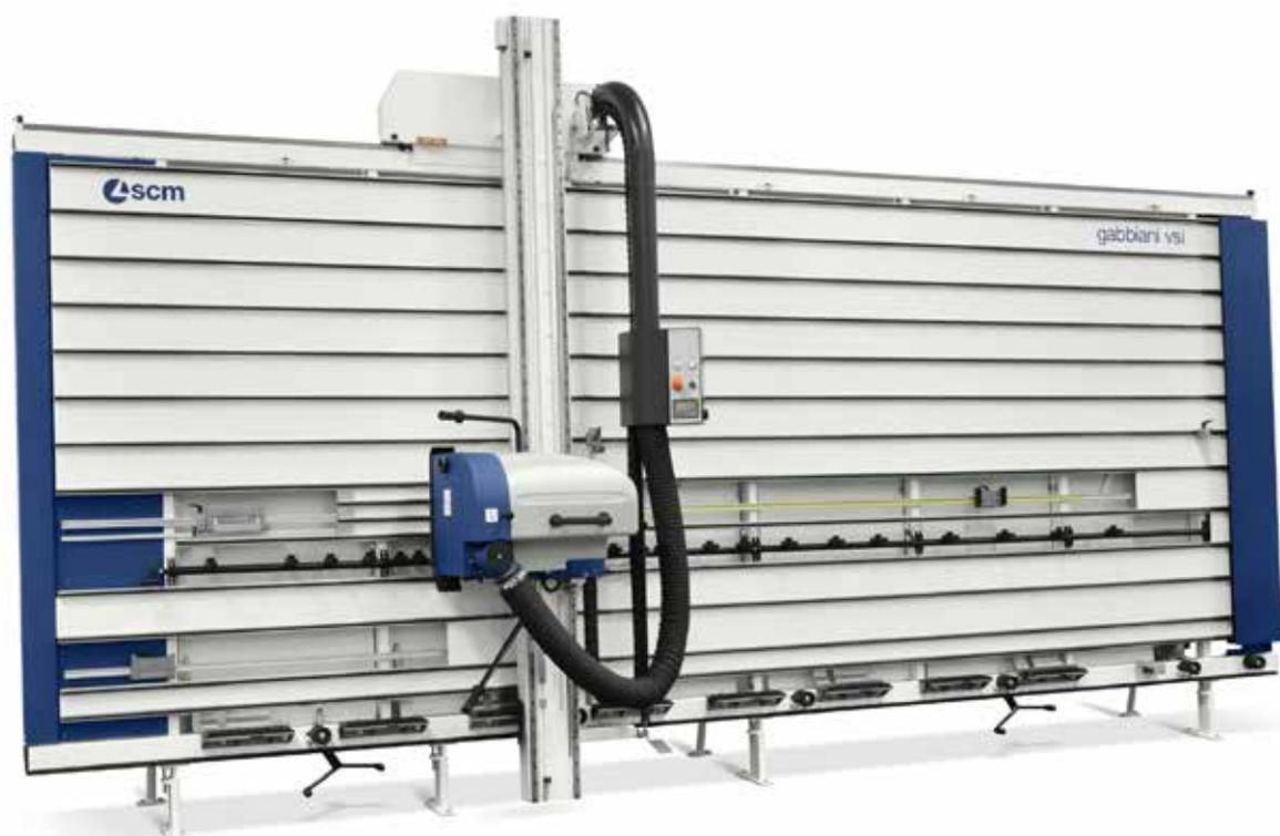
Вертикальный пильный центр с независимыми двигателями для основного диска и зачистного устройства с механическим погружением, предназначен для выполнения горизонтальных и вертикальных пропилов на различных видах древесных материалов.
